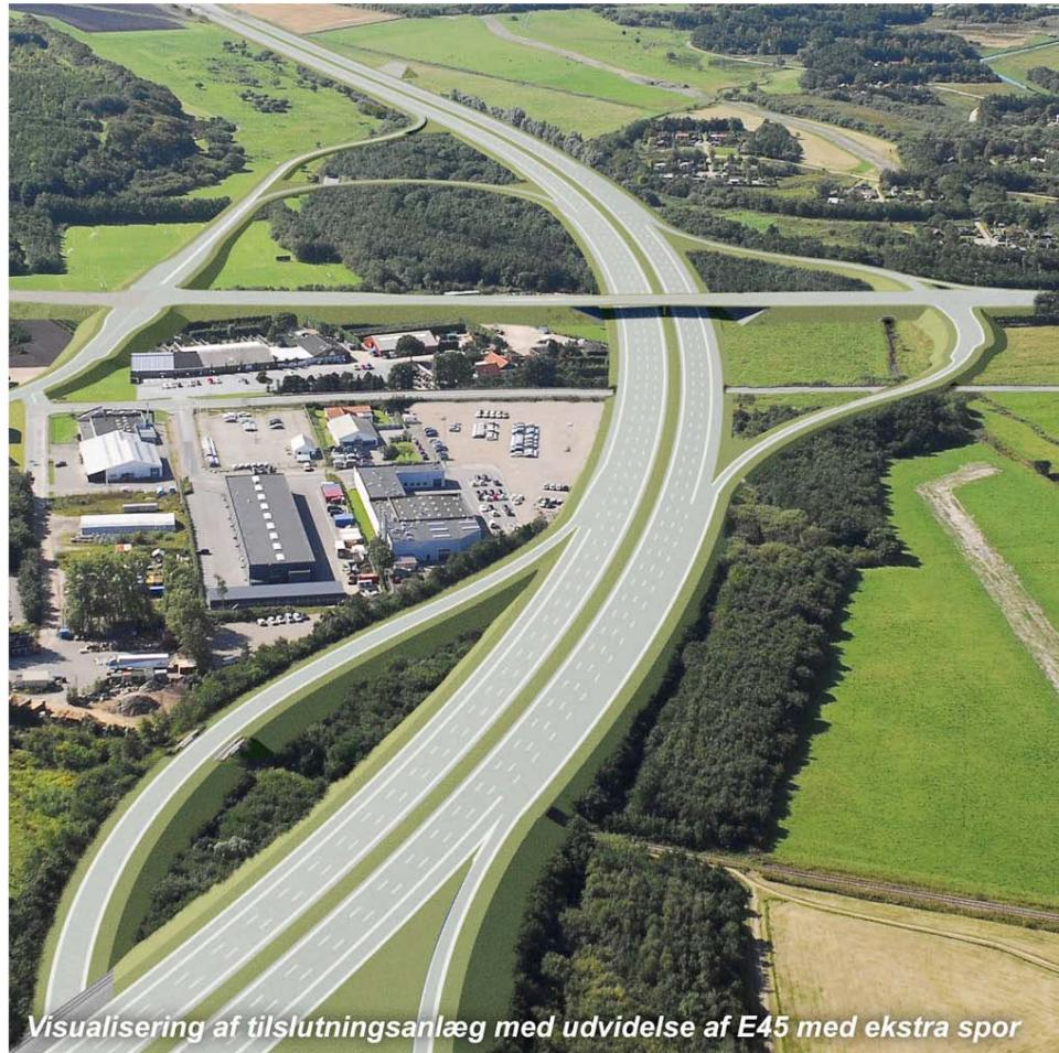
Visualisering af tilslutningsanlæg med udvidelse af E45 med ekstra spor
