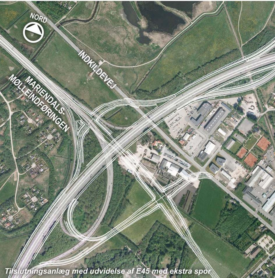
Tilslutningsanlæg med udvidelse af E45 med ekstra spor
