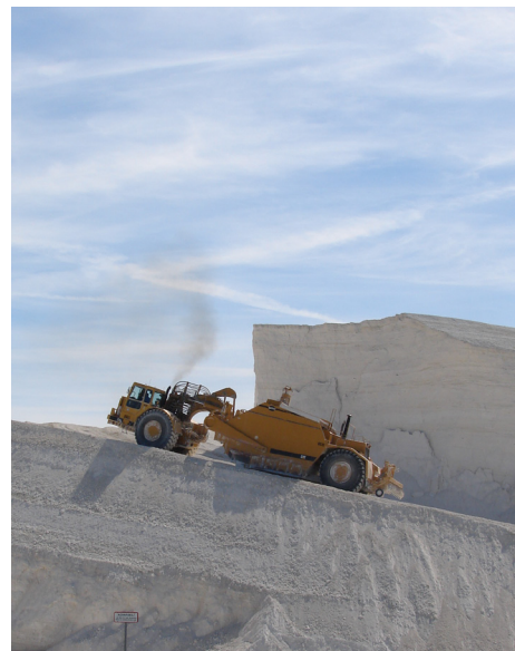
Figur 18: Indvinding af kalk med scraper
