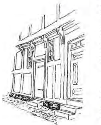
Syldstensfundament på bindingsværkshus.
