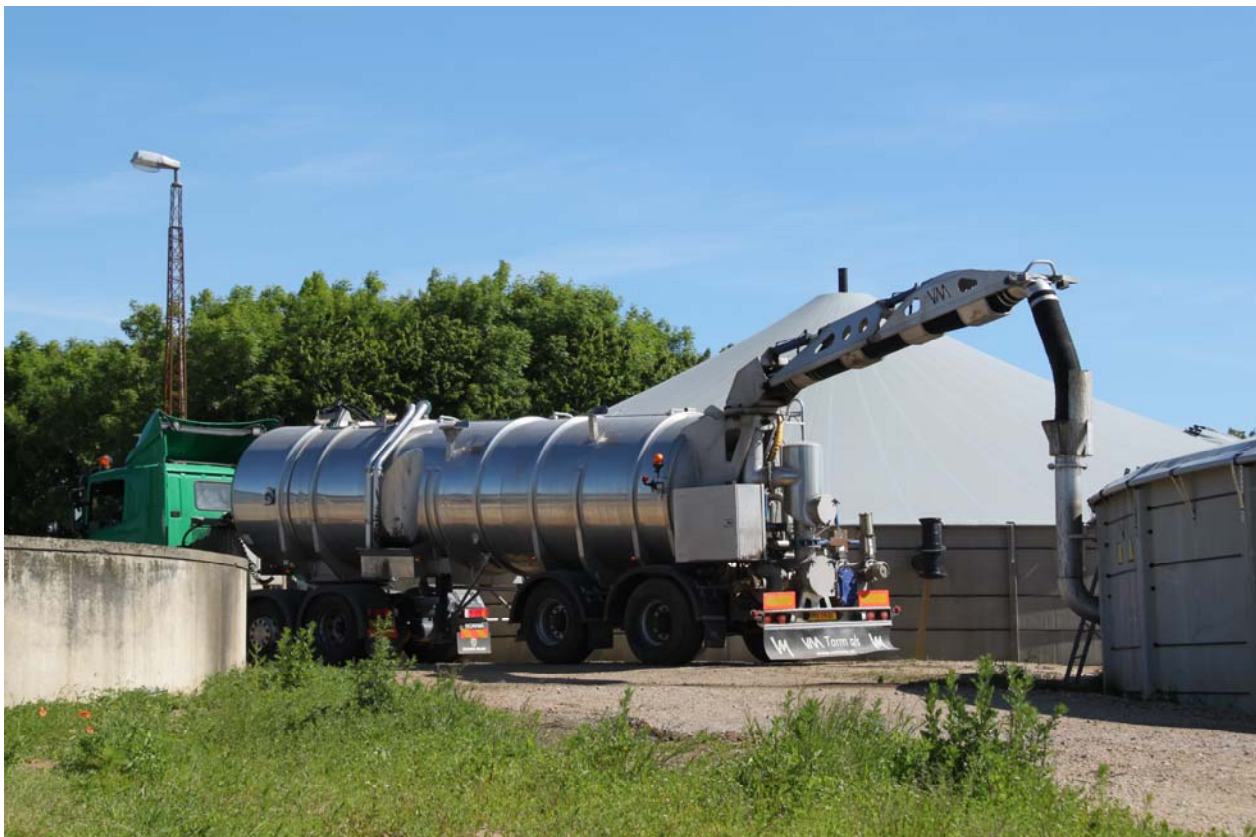
Den afgassede gylle suges op af tankbilen fra lagertanken og køres herefter ud til leverandørernes gyllelagertanke. Foto: Biogassekretariatet.
