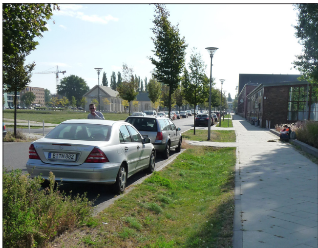
Eksempel på lokal afledning af regnvand (LAR) - grøft til opsamling af vand fra befæstelse i Berlin.
